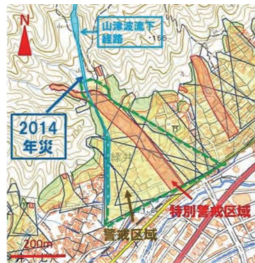
図1 緑井8丁目の土石流危険区域図 2014年災時の山津波流下経路を加筆。
