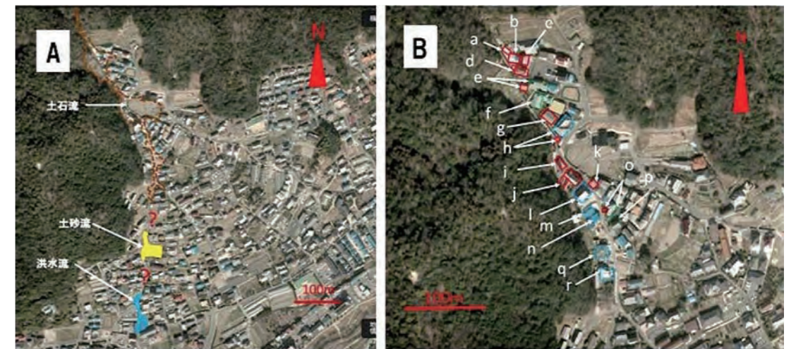
図2 2014年災時の緑井8丁目の被災状況 (A: 山津波(土石流・土砂流・洪水流)の流下経路、B: 被災家屋(赤: 全壊、青: 半壊))
